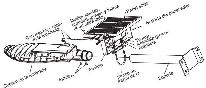
**NOTA:** La luminaria se encenderá automáticamente ante la ausencia de luz. No lo instale al lado de otra fuente de luz artificial (como reflectores o luz de calle); esto impediría que se encienda la luminaria.
