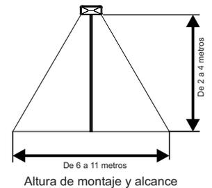
**NOTA:** En todos los modos la luminaria se encenderá únicamente ante la ausencia de luz. No lo instale al lado de otra fuente de luz artificial (como reflectores o luz de calle); esto impediría que se encienda la luminaria.
