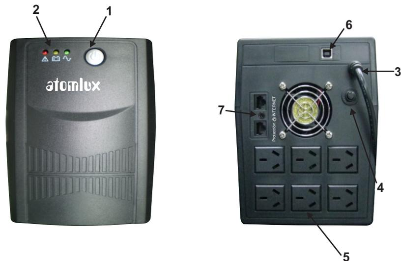
1. **INTERRUPTOR PRINCIPAL:** Se utiliza para encender y apagar el UPS. Si se encuentra encendido (hacia adentro), habrá tensión en los tomacorrientes de salida. Si se encuentra apagado (hacia afuera), no habrá tensión en los tomacorrientes de salida. Independientemente de que el interruptor este en la posición encendido o apagado, las baterías permanecerán en carga mientras la red de energía sea normal.
